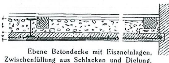
Ebene Betondecke mit Eiseneinlagen, Zwischenfüllung aus Schlacken und Dielung.
